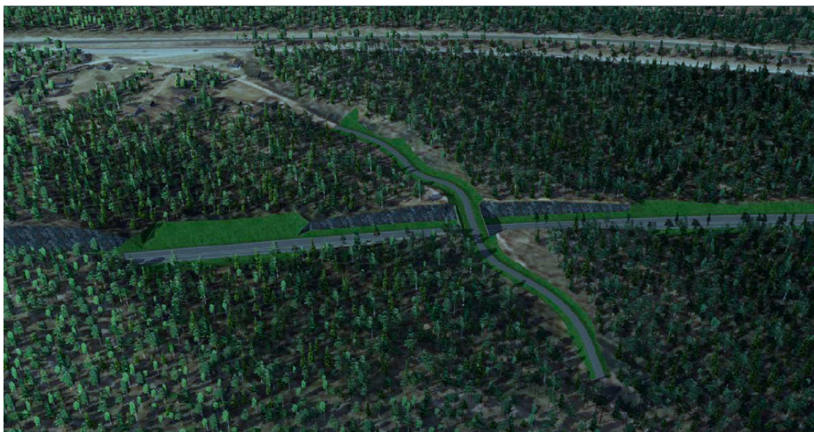
KUVA 27. Hiisiön länsipuolelle Alakyläntien yksityistien kohdalle tehdään riistasilta, jonka kannen leveys on 20 metriä. Havainnekuva sillasta etelästä pohjoiseen (Uudenmaan ELY-keskus ja Kaakkois-Suomen ELY-keskus 2016).
