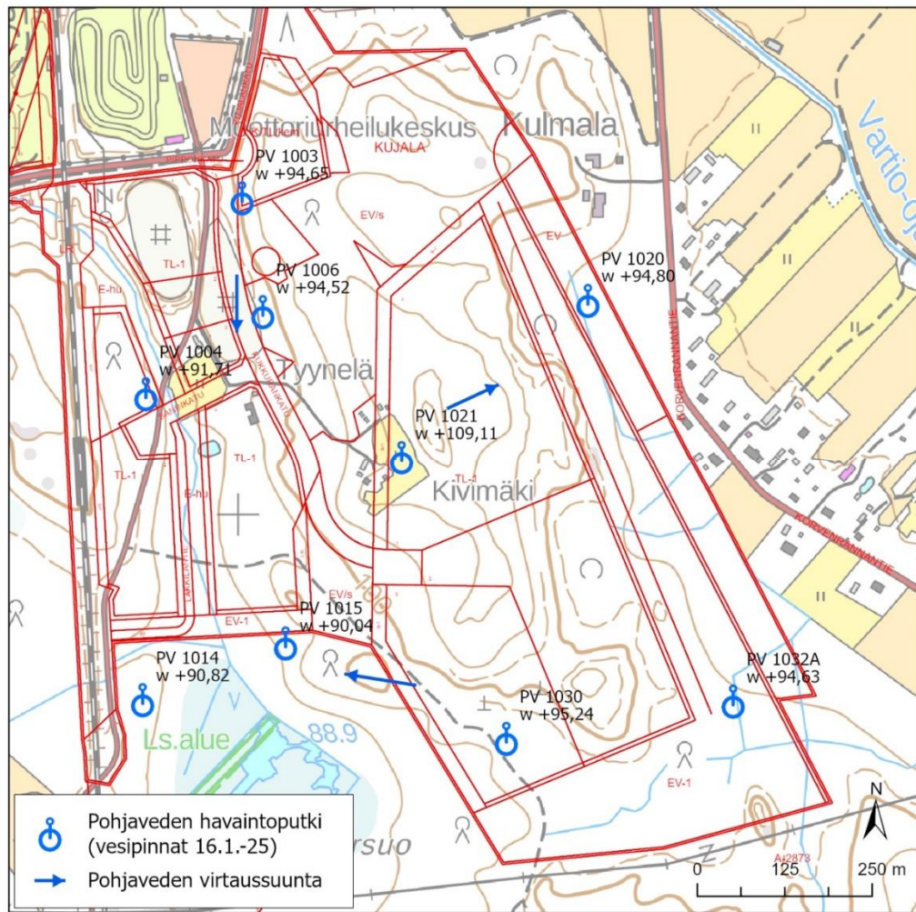
Kuva 16. Suunnittelualueelle asennetut pohjaveden tarkkailuputket sekä 16.1.2025 mitatut pohjaveden pinnankorkeudet. Suunnittelualueen rajauksena on käytetty 2/2025 kaava-alueen rajausta
