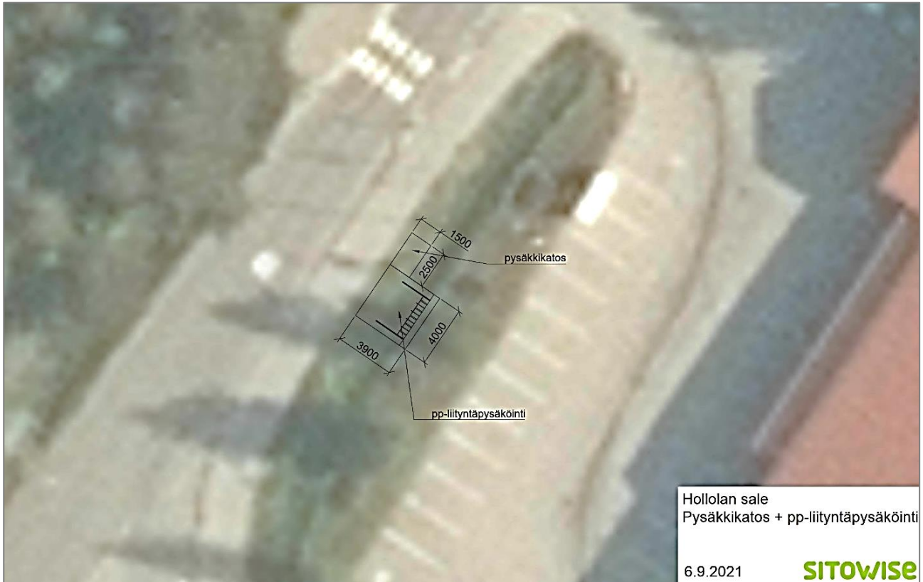
Kuva 21 Pysäkkikatoksen ja pyöräkatoksen sijoittaminen Hollolan Salen pysäkillä
