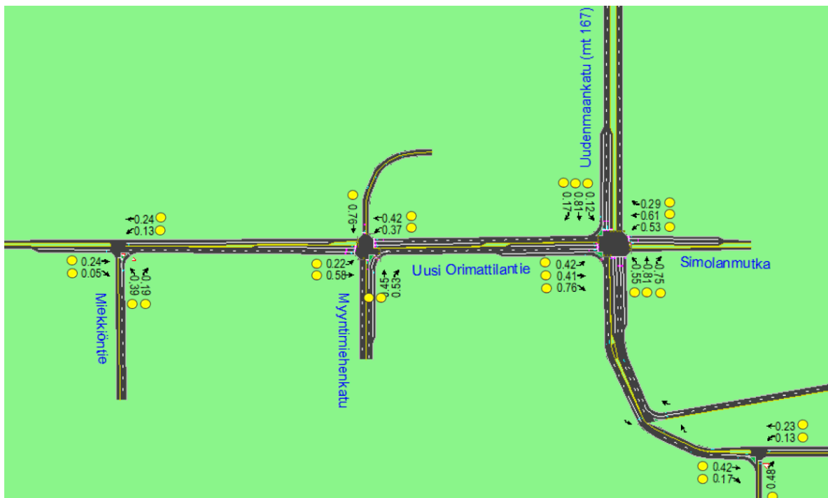
Kuva 18. Nykytilanteen liittymien kuormitusasteet. Kuormitusaste osoittaa, kuinka suuri osuus liittymän maksimivälityskyvystä on käytössä. Kuormitusasteen ollessa 0.5-0.7, liikennevalojen toteuttamista harkitaan sujuvus- ja turvallisuustekijöiden perusteella. Kuormitusasteen ollessa > 0.7 sujuvuuden varmistaminen edellyttää yleensä liikennevalojen toteutusta.
