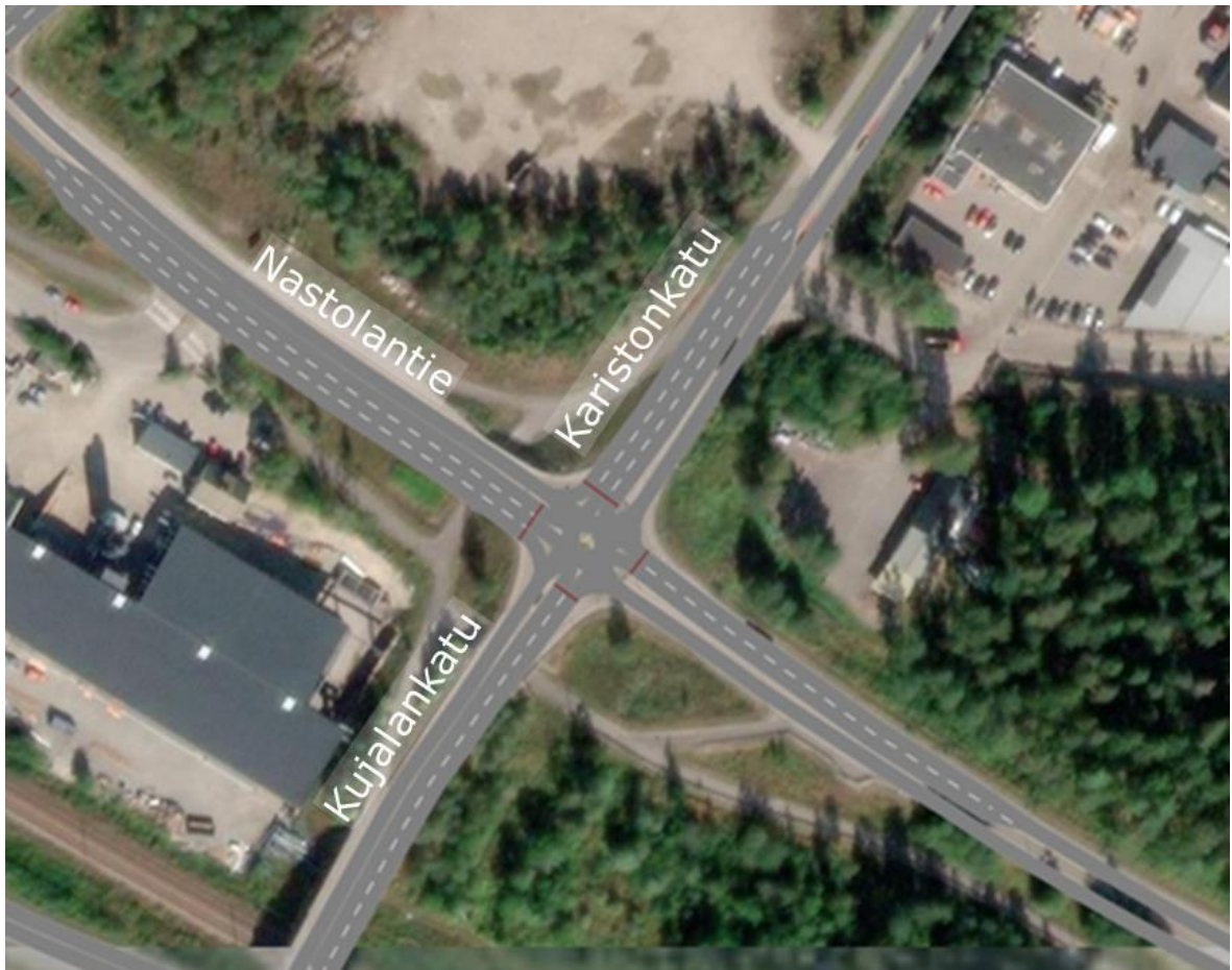
Kuva 41. Kujalan kiertoliittymä muutettuna valo-ohjatuksi liittymäksi.
