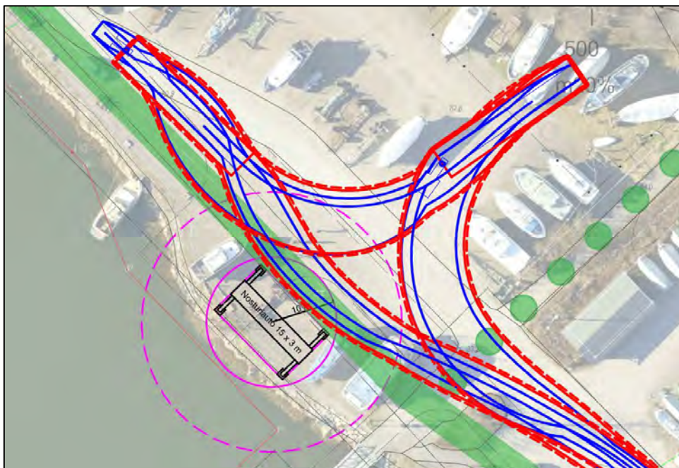
Kuva 1. Ote sataman pohjoisosan nostopaikan ajouratarkasteluista (Liite 8).
