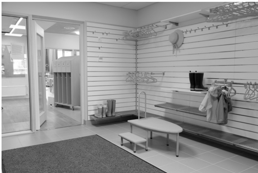
Kuraeteisen ripustusjärjestelmän ansiosta seinäkoukut, vaatetangot, kenkähyllyt ja hattuhyllyt ovat muuntuvia, ritiläkenkähyllyt tippakaukalolla, pukemispenkki.
