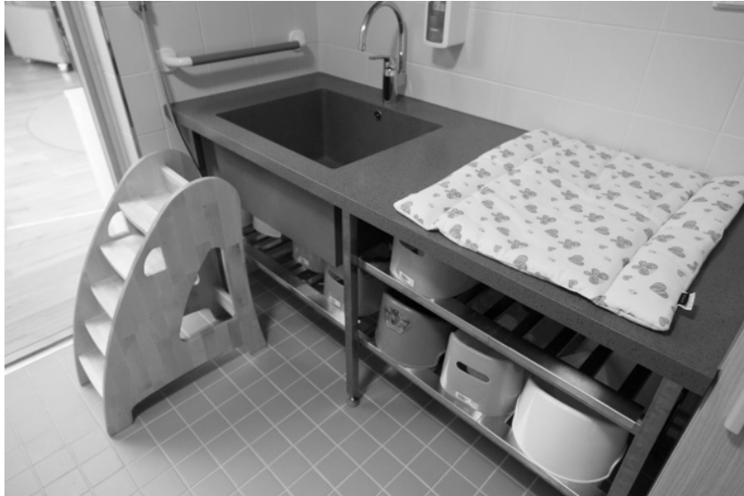
Lähi-wc:n pyllynpesuallas, vaipanvaihtopiste ja pottahylly. Altaan edessä irtokalusteena porrasaskelmat, jotta vartuneemmat lapset voivat itse kiivetä tasolle.
