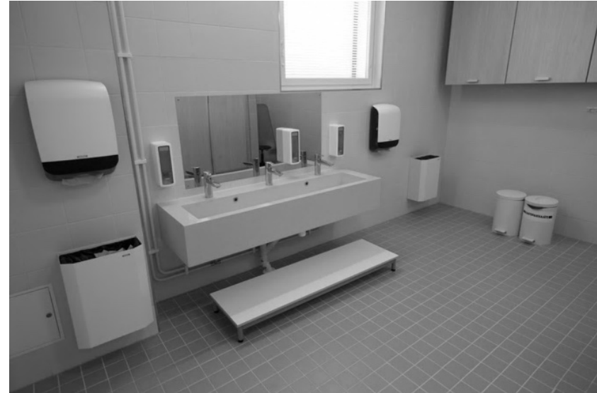
Keskitetty wc-tila, jossa lasten käsienspesupaikka. Varusteissa ja altaissa kiinnitettävä huomiota, että pienetkin lapset ylettävät niihin.
