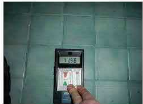
Omakotitalon WC-tilan lattiassa on kohonneita kosteuspitoisuuksia.
