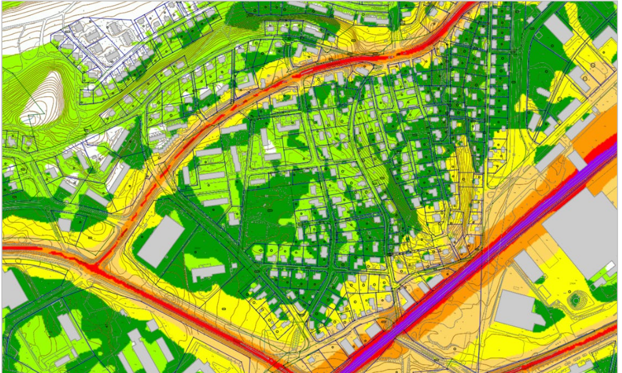
Kuva 4 Ote Lahden meluselvityksestä 2017. Kuvassa näkyy päiväajan (7-22) meluarvot, joiden mukaan suunnittelualueella on päiväsaikaan 50-55dB melutaso (tumman vihreällä)
