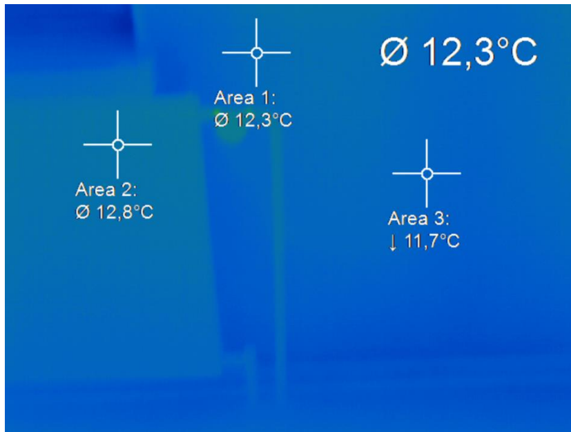
Kuva 5.21 A-talo asunto 3. 1. kerros, pieni makuuhuone. Lämpöpatterit eivät ole toiminnassa ja pintalämpötilat ovat alhaiset.
