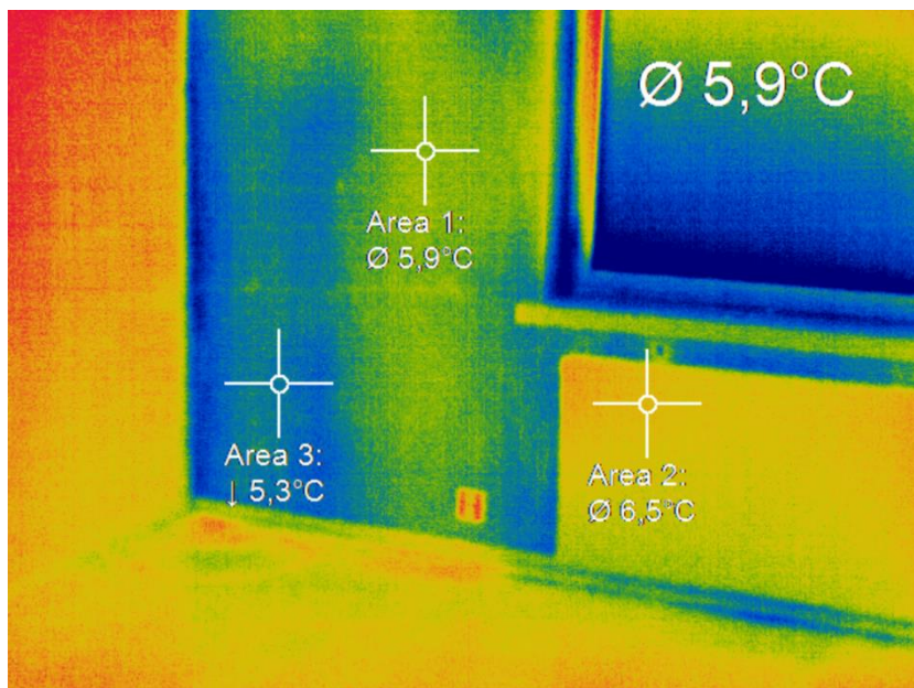
Kuva 5.30 A-talo asunto 3 Ullakko, Iso makuuhuone. Kuvan 5.29 väriskaalaa on muutettu tuomaan esille kylmimmät alueet.
