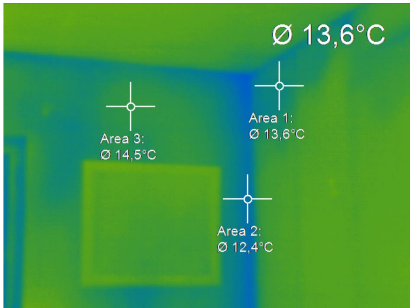
Kuva 5.31 B2-talo asunto 7 Ullakko, Iso makuuhuone. Seinällä esiintyy kylmempiä alueita, mahdollisesti sahanpuru eriste ei täytä eristetilaa kokonaan.
